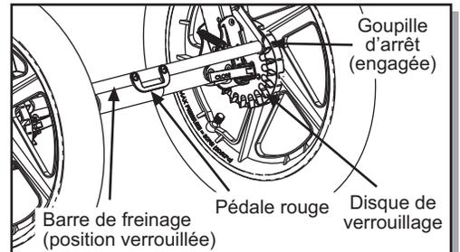
Fig. 16 Frein de stationnement – position verrouillée.
