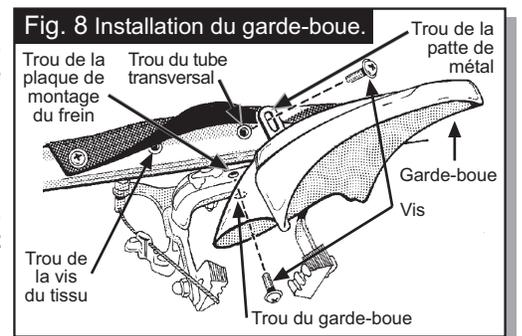
Fig. 8 Installation du garde-boue.
