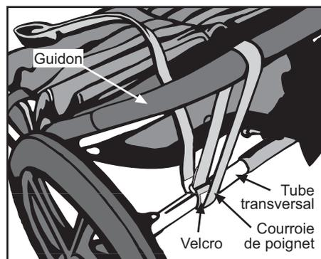
Fig. 27 Attache la poussette en position repliée.
