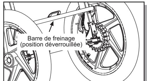
Fig. 17 Frein de stationnement – position déverrouillée.
