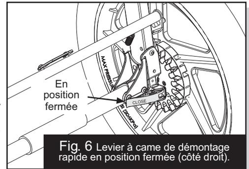
Fig. 6 Levier à came de démontage rapide en position fermée (côté droit).
