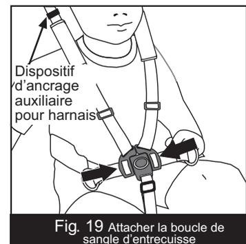
Fig. 19 Attacher la boucle de sangle d'entre-cuisse
