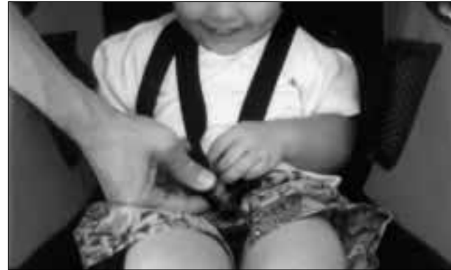
Fig. 22 - Place straps over shoulders and secure to D-ring. Placement des straps au dessus des épaules et fermeture centrale. Legen Sie beide Schultergurte an und befestigen Sie sie am D-Ring.
