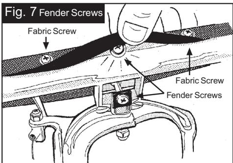
**Fig. 7** Fender Screws
