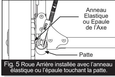
Fig. 5 Roue Arrière installée avec l'anneau élastique ou l'épaule touchant la patte.
