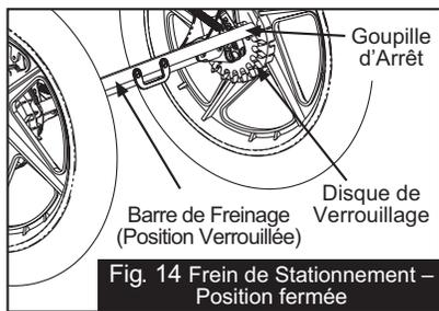
Fig. 14 Frein de Stationnement - Position fermée
