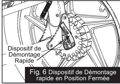
Fig. 6 Dispositif de Démontage rapide en Position Fermée
