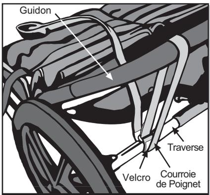
Fig. 24 Attachez la poussette en position pliée
