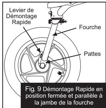
Fig. 9 Démontage Rapide en position fermée et parallèle à la jambe de la fourche
