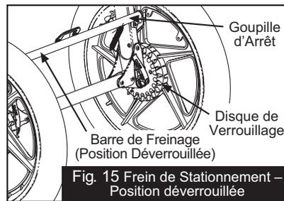
Fig. 15 Frein de Stationnement - Position déverrouillée
