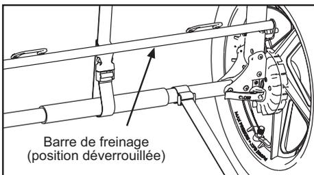
Fig. 15 Frein de stationnement – position déverrouillée.
