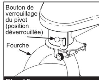
**Fig. 10** Verrouillage du pivot – position déverrouillée (mode pivot).
