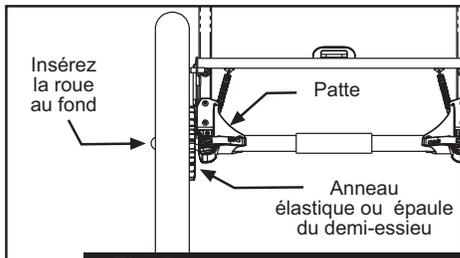
**Fig. 5** Roue arrière installée correctement (côté gauche).
