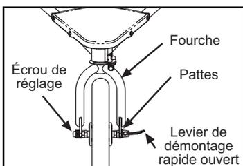
**Fig. 8** Serrez l'écrou de réglage avec le levier de démontage rapide ouvert.
