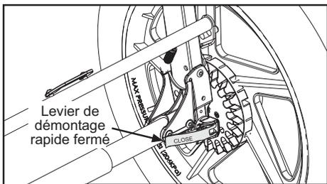
**Fig. 6** Levier de démontage rapide fermé (côté droit).
