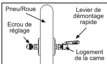
**Fig. 7** Description du dispositif de démontage rapide de la roue avant.
