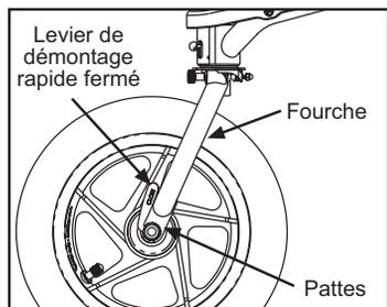
**Fig. 9** Démontage rapide en position fermée, parallèle à la patte de la fourche.
