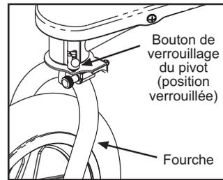
**Fig. 11** Verrouillage du pivot – position verrouillée (mode jogging).
