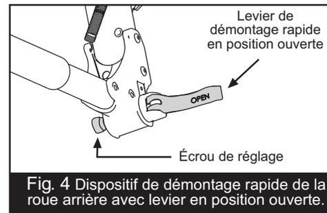
**Fig. 4** Dispositif de démontage rapide de la roue arrière avec levier en position ouverte.
