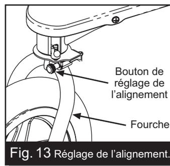
Fig. 13 Réglage de l'alignement.
