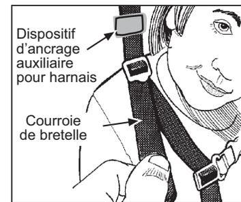
Fig. 17 Ajustez avec soin les courroies de bretelle.
