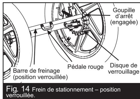
Fig. 14 Frein de stationnement – position verrouillée.
