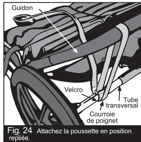
Fig. 24 Attachez la poussette en position repliée.
