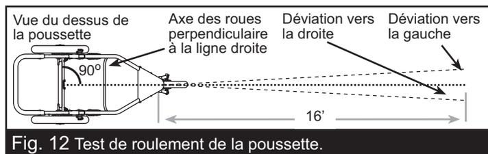
Fig. 12 Test de roulement de la poussette.
