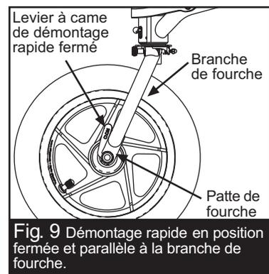
Fig. 9 Démontage rapide en position fermée et parallèle à la branche de fourche.
