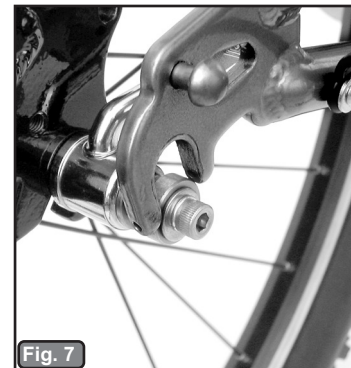
Fig. 7 Espace de l'attache non aligné avec le crochet
