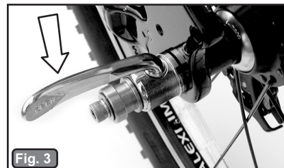
Fig. 3 Levier de fixation rapide perpendiculaire au côté de la patte arrière
