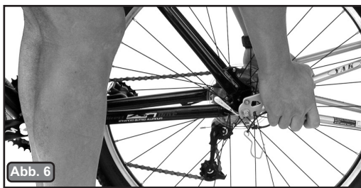
Abb. 6 Richtige Stellung zum Ankuppeln des Anhängers
