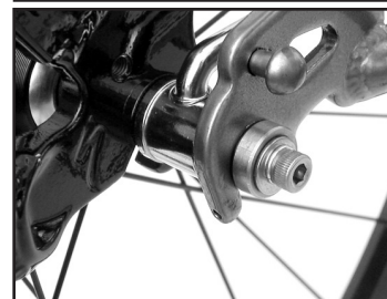
Abb. 8 Korrektur auf den Spezialaufnahmen montierte Ausfallenden der Deichsel
